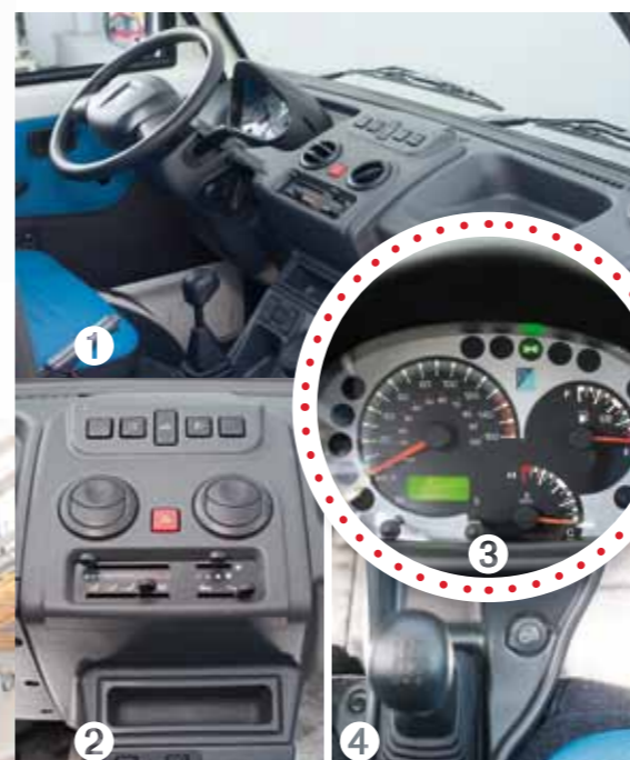
1 Cabină restilizată, cu o bună vizibilitate exterioră 2 Multe dintre echipamente sunt opționale, dar lista este bogată. 3 Vitezometrul e marcat în kilometri și mile, iar informațiile oferite sunt minime, dar suficiente. 4 Cutie de viteze cu cinci trepte având o etajare care favorizează deplasarea în sarcină.
